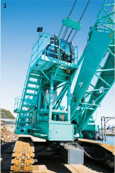
1.キャブからの下方視界を確保するためメッシュ状にした足場。キャブへと昇降しやすいよう、階段の角度と幅にもこだわって設計されている 2.マグネット用の操作レバーは、乗降時の妨げにならないよう可動する 3.4.キャブのアイポイントは5.8m。船の荷台の底近くまで見渡しながらの作業が可能だ
