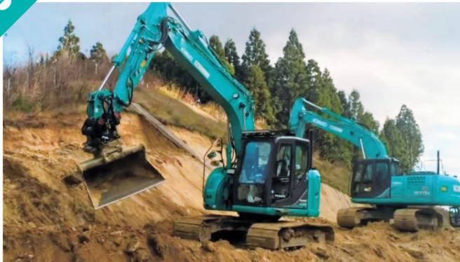
1.バケットの反転や微細な角度調節が可能なチルトローテータは、アタッチメントの交換もスピーディー。運転席に座ったまま、秒単位で取り換えられる 2.チルトローテータにオプションで付けられる「カニヅメ」を使えば、瓦礫なども簡単につかめる 3.「カニヅメ」を使い、杭抜き作業に従事するSK135SRD
