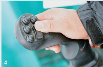
4.チルトローテータはゲームのコントローラー感覚で簡単に操作できる 5.オペレータの佐藤清志さんは、掘削する深さや法面の角度も設定できるマシンガイダンスシステムを絶賛。フル稼働しても丸2日は保つコベルコ機の燃費性能も高く評価する
