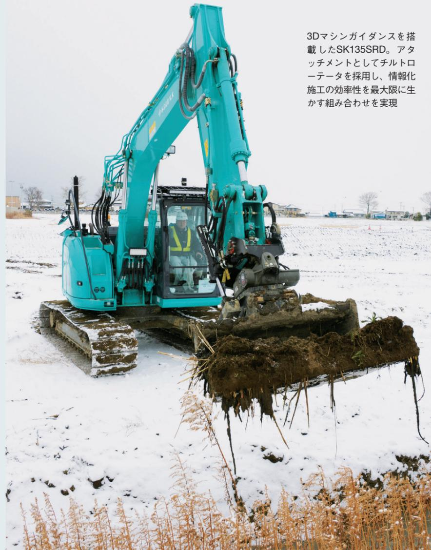
3Dマシンガイダンスを搭載したSK135SRD。アタッチメントとしてチルトローテータを採用し、情報化施工の効率性を最大限に生かす組み合わせを実現
