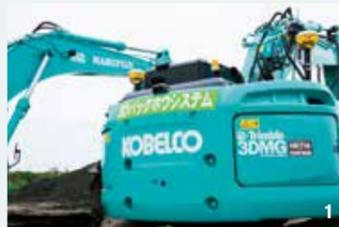
1.ホルナビ搭載機種では、後方に設置したアンテナで衛星情報を受信している
