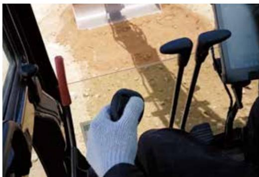
アームレバー操作だけで、設計面に沿った施工が実現。習得までに多くの経験を要する「ブーム」「アーム」「バケット」の複合操作を半自動化することで、誰でも熟練オペレータ並みの生産性と精度を実現する
