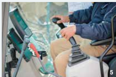
4. オペレータの清水雅史さん。「ホルナビ+PLUS搭載機を使えば、作業効率が向上し、工期の短縮にもつながるなど、プラス面しかないですね」 5. オペレータは、アームレバー操作のみでショベルの掘削作業におけるアクションを半自動で制御可能に 6. 岡田さんと事務の仕事を手を仕切る齋藤京美さん
