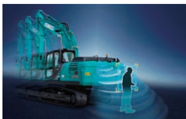
建機メーカー初の衝突軽減システム『K-EYE PRO』。現在は20tクラスのオプションだが、今後は標準化やその他のクラスへの搭載も目指している
