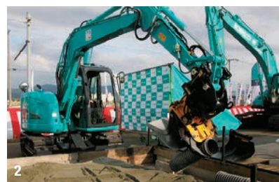
1.チルトローテータ搭載のSK200 2.〇×ゲームをするチルトローテータ搭載のSK75SR
