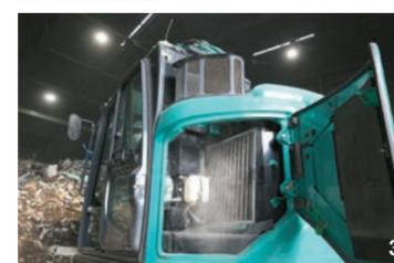
1.SK75SRD-7Rに搭乗するのは、オペレータ歴10年の山本さん。「右側面の視界が広く、作業がしやすくなりました。車載カメラも3台搭載され、安全性は格段に高まっていると思います」2.「モニター画面が大きくなり、計器類が見やすくなりました。ジョグダイヤルは操作がしやすく、例えばエアコンの調節も簡単に行えます」(山本さん)3.SK75SRD-7Rは、iNDRの進化型である「iNDR+J」を搭載。機内からのジェット噴射により防塵フィルタに付着した粉塵を取り除く機能で、メンテナンスの手間がこれまで以上に軽減。2~3日何もなくても問題ないという
