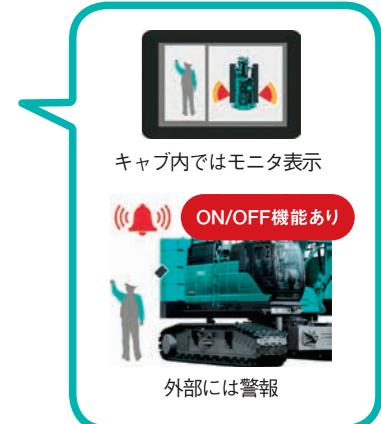
衝突軽減システム「K-EYEPRO」は、ショベルが先行して開発・実装してきたシステムだ。現在、運転中のオペレータの死角エリア内の人や障害物を検知することによって、事故を未然に防止するその機能を、クレーンに適用するプロジェクトが進行中。
