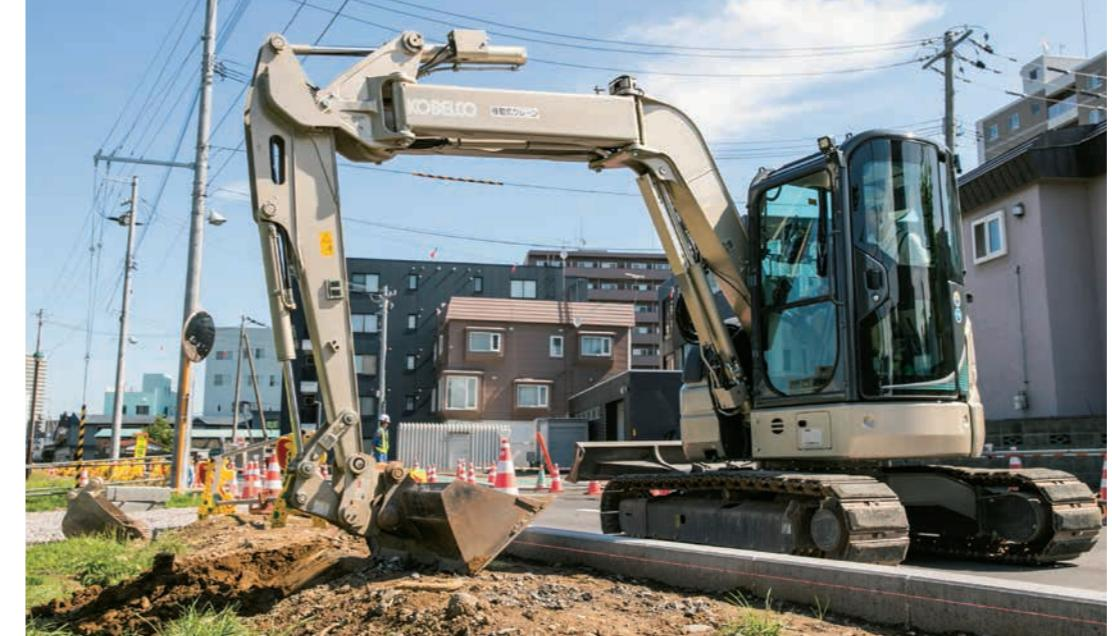
センサ間は無線通信式のため、ケーブルを気にすることなく作業に集中できる。さらに、マストも不要で狭所での作業性も確保している。車体各部にワントッチで装着可能なセンサが付いており、車体の傾きとオフセットブーム角を検知。現場での取り付け、取り外しも簡単に行える
