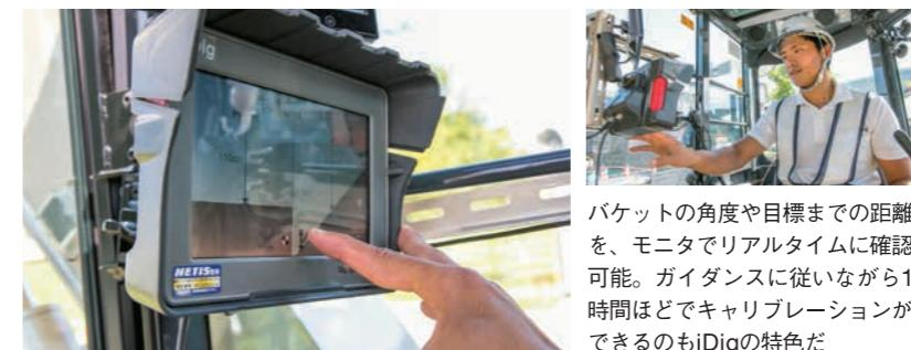
バケットの角度や目標までの距離を、モニタでリアルタイムに確認可能。ガイダンスに従いながら1時間ほどでキャリブレーションができるのもiDigの特色だ
