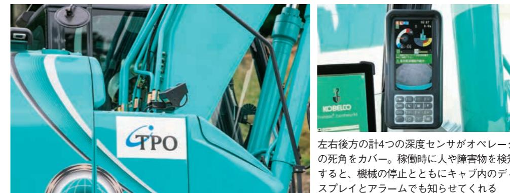
左右後方の計4つの深度センサがオペレータの死角をカバー。稼働時に人や障害物を検知すると、機械の停止とともにキャブ内のディスプレイとアラームでも知らせてくれる
