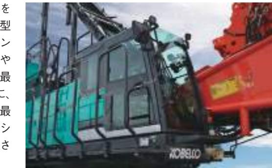
足下から頭上まで、全方位で視界を遮らない視野の広さが自慢の新型キャブ。ヒータ付きエアサスペンションシートや、レバースタンドやシートのスライド幅拡大で、より最適な姿勢をサポートする。さらに、操作する人を選ばず、使いやすく最善の操作を支援するオペレータアシスト機能で快適性や操作性を向上させ、作業負荷の軽減を実現する。
