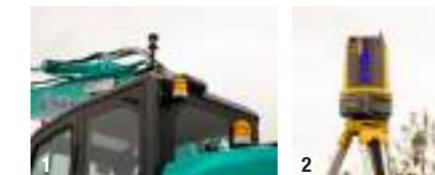
1.ショベル側に設置したプリズムを杭ナビ(LN-150)が追尾し、ショベルの位置を正確に把握。3次元設計データと刃先の座標値を比較し、設計面との差をタブレット画面に表示させる 2.従来の自動追尾TS(トータルステーション)を簡易かつ安価にした杭ナビ(LN-150)
