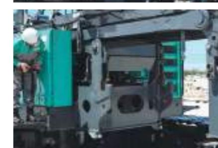
独自の設計で、ガントリの取り付け・取り外しをスマートにした「ガントリクイックセット」
