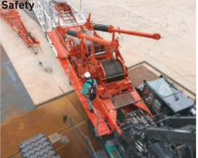
コンパクトボディを継承しながら、さらに大きなパワーを発揮。クレーン仕様で従来機比最大約10%、タワー仕様では最大約25%のつり上げ能力の向上により、あらゆる現場で、余裕を持った作業を実現する。同時にブームの剛性を強化し、特に下部ブームは従来機同様のフット幅1,430mmを維持しつつ、ねじれやたわみを低減させ、優れた操作性も確保している。
