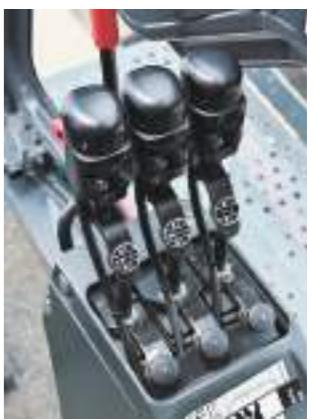
主巻・補巻・起伏レバーに、速度調整トリマとカメラ切替スイッチを配置した「多機能操作グリップ」を採用し、レバー操作中の各機能活用を可能とした。また、ドラムの初動をリアルタイムで検出するドラム回転感知機能も搭載。さらに「レバーコントロールモード」と「アクセラコントロールモード」により、操作する人に合わせて自在な選択・切り替えが可能となった。
