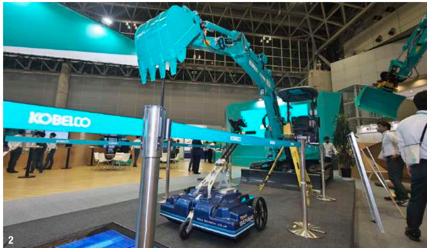
1. ブース内ステージではプレゼンテーションも実施 2. 参考出展の地中探査・杭ナビショベル
