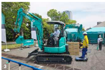
3. 屋外ブースでのミニショベル向け衝突軽減装置 OmniEye®のデモンストレーション 4. チルトローテータ各種アタッチメントの紹介とともに、交換作業も実演
