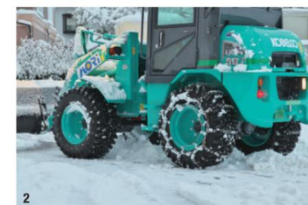
1.水分量が多くて重い福井県の雪もなんのその。コベルコ建機のミニホイールローダLK50Zは、コンパクトなボディながら力強い作業性能が魅力だ 2.走行性能の高さも、LK50Zの特長の1つ。除雪作業時はもちろん、スピーディーに移動できる機動力も備えているため、現場が遠くても運転が苦にならない
