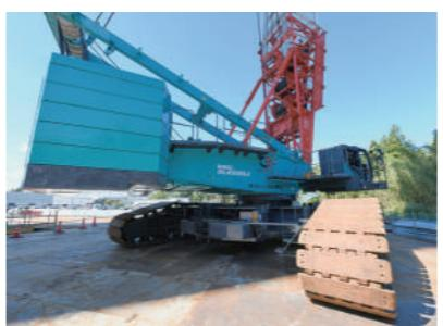
SL4500Jは、本現場で最も大きなクラスのクローラクレーン。キャブにはチルト機能が付いており、長時間におよぶ高揚程作業でも無理なく操作が可能だ
