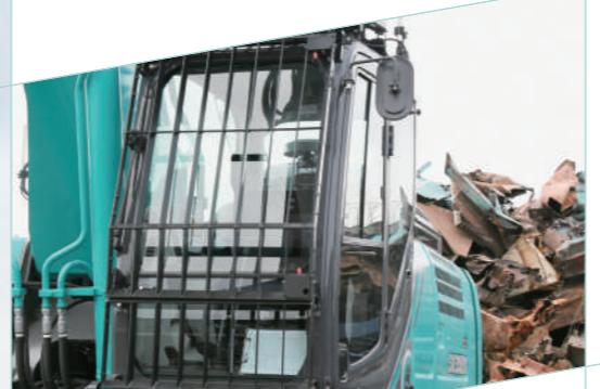
ヤード内にあるコックピットからの遠隔操作により、無人の重機が鉄スクラップを切断中。今後は、マグネットやグラップルを装着しての作業や、コックピットから遠く離れた現場にある重機の遠隔操作も試す予定だ
