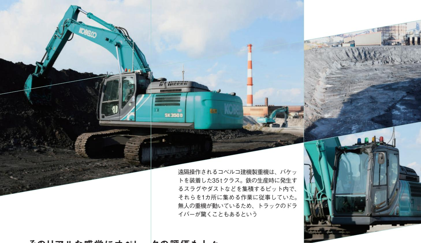
遠隔操作されるコベルコ建機重機は、バケットを装着した35tクラス。鉄の生産時に発生するスラグやダストなどを集積するピット内で、それらを1カ所に集める作業に従事していた。無人の重機が動いているため、トラックのドライバーが驚くこともあるという
