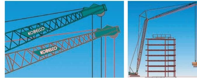
コベルコ建機のクレーンであれば、吊荷重に応じたクレーンの「たわみ」を表示可能。経験頼りだった仮設部材との干渉チェックも、たわみを考慮して確認でき、より安全な現場を支援。
