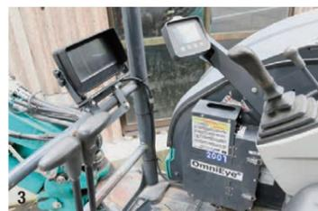
1.機械に近づく人を単眼カメラ（半球カメラ）で検知し、AIが人かモノかを判別する 2.衝突の可能性が高いとシステムが判断したときに、光と音でオペレーターに知らせる警告ランプ 3.ドライブレコーダー機能を備えたコントロールボックス
