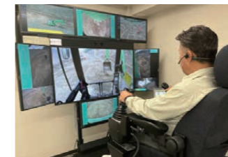
現場から約70km離れた富島建設社(大阪市)から遠隔操作で作業
