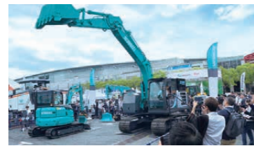
注目度が高かった水素燃料電池ショベルの稼働実演
