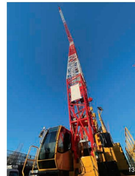
現在、コベルコ建機製のクローラクレーンを計18台保有。200tクラスでは、1型・2型・Gシリーズ・NEOと、全ラインナップを網羅している
