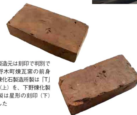
煉瓦の製造元は刻印で判別できる。野木町煉瓦窯の前身の東輝煉化石製造所製は「T」の刻印(上)を、下野煉化製造会社製は星形の刻印(下)を使用した
