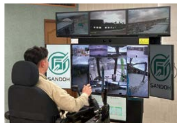
大阪・関西万博での稼働実績：通信衛星（Starlink）を用いた「SK135SRD-7」解体仕様機の遠隔操作
