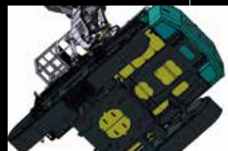
強化型上部本体アンダカバーおよびロワアンダカバー 6mm厚の鋼板製カバーが本体内部機器を保護および9mm厚の鋼板製カバーが走行系油圧回路を保護。
