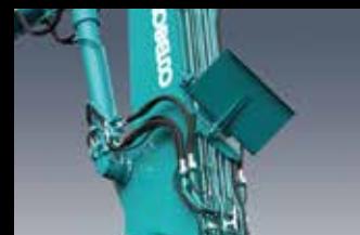
破砕片ストッパ (超ロングアタッチメント仕様のみ) ガードにより、落下してくるがれきが機械本体へ当たるのを防ぎます。なお、この装備は3つ折れ超ロングアタッチメント仕様では標準装備です。
