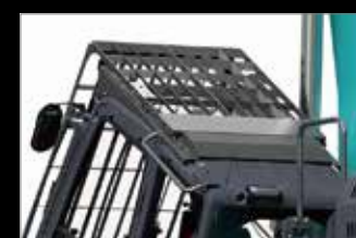
キャブトップガード キャブトップガードは開閉式で、窓ガラスの清掃が容易です。
