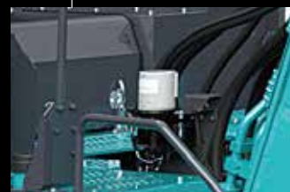
アタッチメント自動給脂装置 決められた時間ごとに自動的に給脂。始業時給脂の煩わしさをカット。
