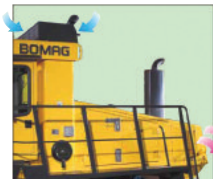
エンジン前方の高い位置にエア吸入口を設置。粉塵の流入を防ぎます
