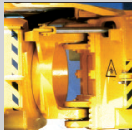
ドライブシャフトが存在しないセンタージョイントにより高い自由度を実現
