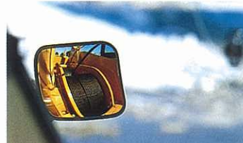
▲ドラムミラーでドラムの巻取状態もひと目で。
