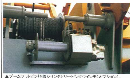
▲ブームフットピン脱着シリンダとリーピングウインチ(オプション)。
