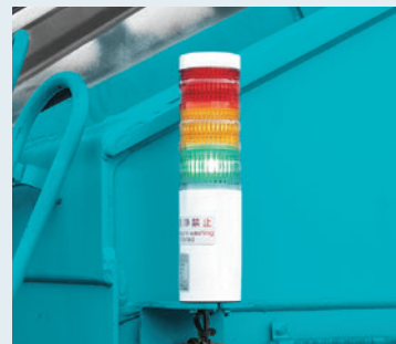
過負荷外部表示灯
