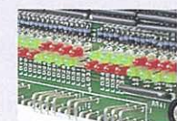
●すばやい故障診断を可能にした多重伝送入出力ランプ表示。
