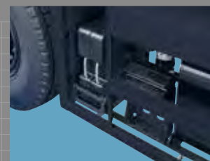
盤木収納とタイヤ輪止め(右側)
