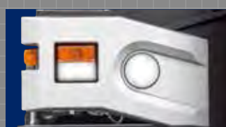
ブーム先端に被視認性を高める高輝度のLEDライトを装備しています。
