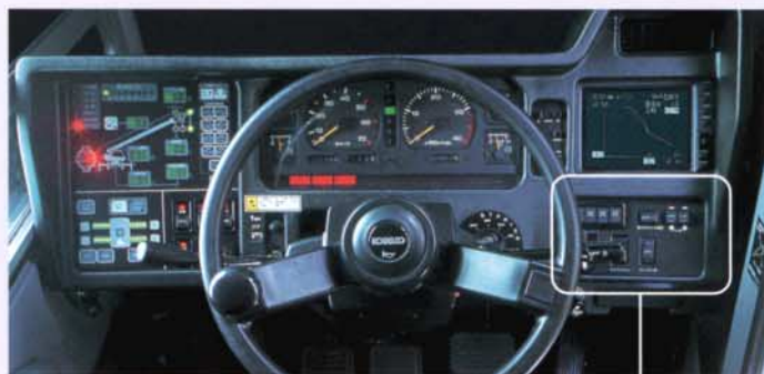
●ステアリングモード切り換え ●サスペンション フリー/ロック切り換え ●2WD/4WD切り換えの各スイッチ
