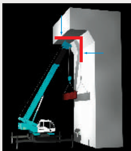
図はブームトップ高さ、作業半径の制限制御です。旋回角度の制限制御もできます。
