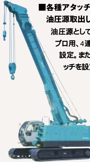
掲載写真はオーガ用油圧源2、パイプロ用油圧源、4連バルブ装備仕様
