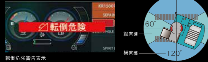
転倒危険警告表示
