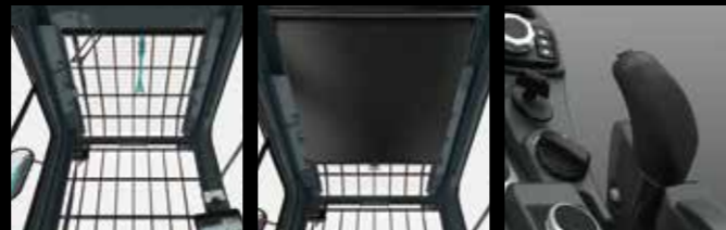
広く、安全確認しやすい作業視界を確保したDSキャブ 縦開閉のロールブラインドを採用した天窓 4つ折れ超ロング仕様機用操作レバーを手元に配置
