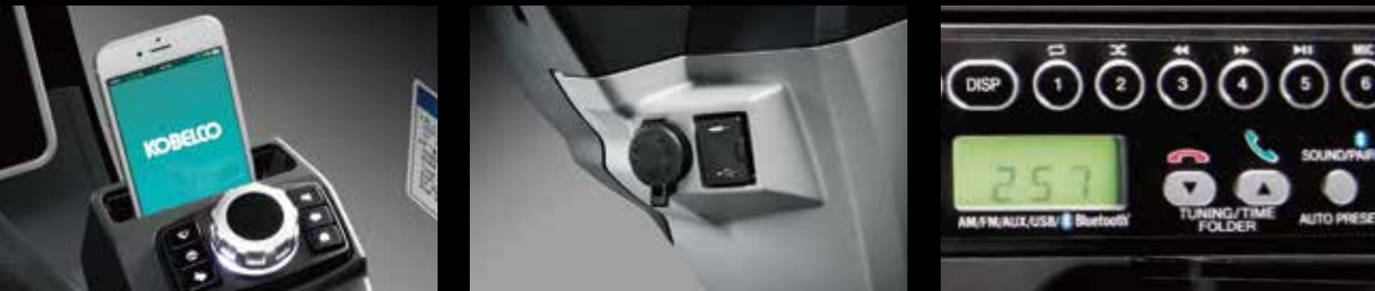
スマートフォンホルダ 24V電源 / USBポート FM/AM Bluetooth® (ハンズフリー) ラジオ
