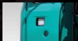
上部本体右作業灯
