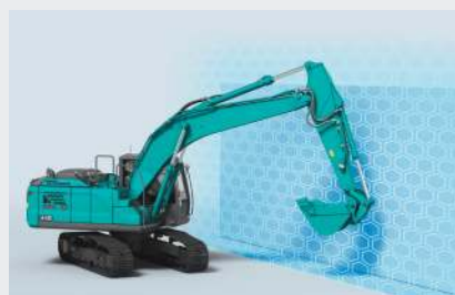
旋回操作時の接触防止
