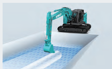
地下の水道管などへの接触防止
