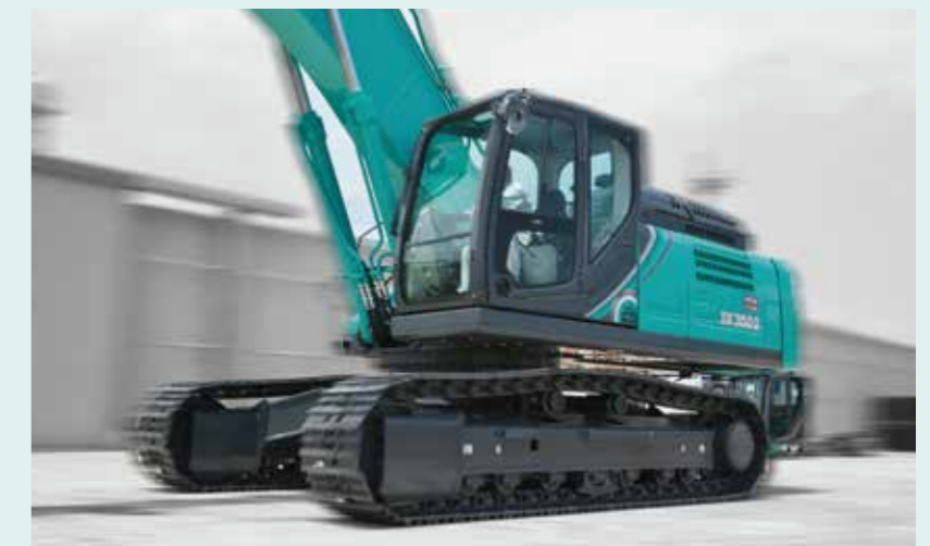
※写真はガードを外した解体仕様機です。
