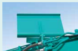
破碎片ストップパ 破碎片の背滑りを防止。NEXT超ロングアタッチメントに標準装備。
