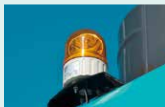
黄色回転警告灯 周辺作業者に稼働中であることを知らせ注意を喚起。 オプション
