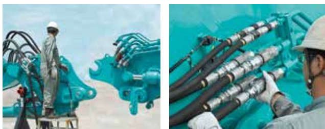
配管接続: 地上ですばやく行えるブーム側面クイックカブラ方式。
