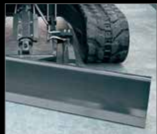
チルトアングルドーザ 対象機: SK45SR-7E、SK55SR-7E
