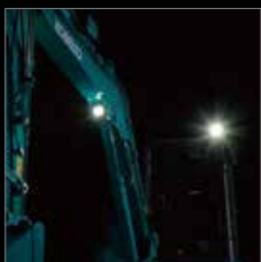
LED前方作業灯 (キャブ 2カ所、キャンピ1カ所) 画像はキャブ仕様。
