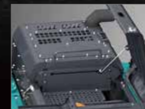
エンジンメンテナンス 主要箇所へのアクセスを 考慮した開口部。
