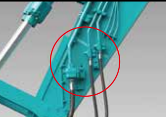
回転F&G 配管 先端アタッチメントにフォークグリップまたはグラップルバケットの装着が可能。
