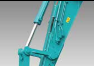
中通しマグネットケーブル アーム背面からイドラリンク間を通して接触による破断を防止。
