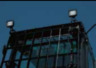
キャブ2 LEDライト 薄暮・夜間作業時や屋内作業時に前方をより明るく照らし視認性を向上。
