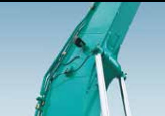
HD2 ポジションブーム 標準ブームに比べて大きな作業高さとし作業半径を実現。
