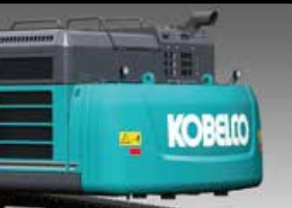
SP増量ウエイト 機体の動安定性を確保し作業効率を高めるスペシャル増量ウエイトを搭載。
