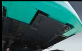
強化型上部本体アンダカバー 6mm厚の銅板製カバーが本体内部機器を保護
