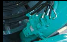
セーフティ配管(ブーム) 配管破断時のアタッチメント落下を防止
