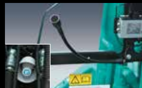
1WAYコール(拡声器システム) クリアな音声品質で周辺作業者に注意を喚起
