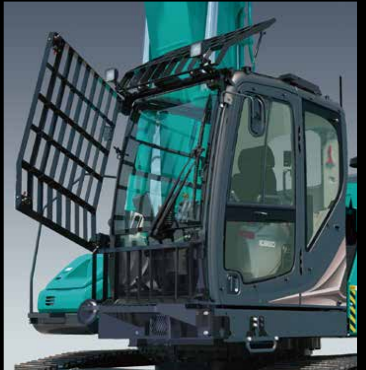
清掃がしやすい開閉式のキャブガード(前窓上部・天窓)
