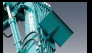
破砕片ストッパ(超ロング仕様) 高所解体時の破砕片背滑りを防ぎ、オペレータの安全を確保
