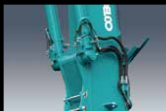
セーフティ配管 ブーム、ジブなど主要シリンダの配管にホールディングバルブを装備。
