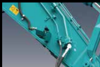
散水装置 解体作業で発生する粉じんの飛散を防ぐのに役立ちます。
