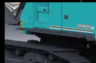
格納式キャットウォーク より安全にメンテナンスが行えるように本体左側に加え本体右前にも設置。
