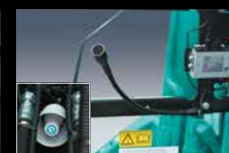
1WAYコール(拡声器システム) クリアな音声品質で周辺作業者に注意を喚起。
