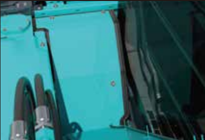
センターカバー （旋回モータ上／ブーム配管出口） 枯葉などが溜まりやすいブームフット下方にカバーを装備。 ※写真はSK75SR-7Fです。
