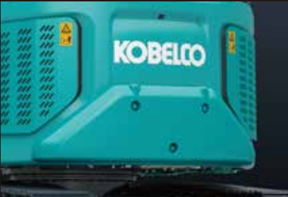
SK75SR 追加ウエイト (+300kg)（オプション）※1 SK135SR 追加ウエイト (+580kg) 重量のあるアタッチメントを使用する際も、機体バランスを維持し安定した作業が可能です。 ※写真はSK135SR-7Fです。 ※1 ウインチ装着時には選択できません。
