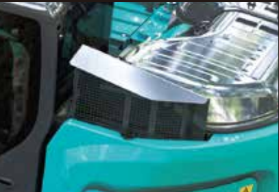
枯葉・積雪ガード（オプション） 機体への枯葉や積雪の侵入を防止。後方視界を妨げないように形状にも配慮しています。 ※写真はSK135SR-7Fです。
