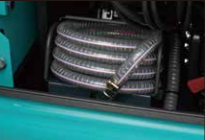
燃料給油ポンプ（SK135SRのみ） 電動の燃料給油ポンプを標準装備することで、現場での給油作業がスムーズに行えます。
