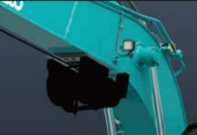
ウインチ仕様 各社地引ウインチに対応したベースプレート及びワイヤ固定用吊環、ウインチ用配管が付いたブームとキャブ内にはウインチ操作スイッチボックスが設定されます。 ※写真はSK135SR-7Fです。ウインチ本体は付属しません。
