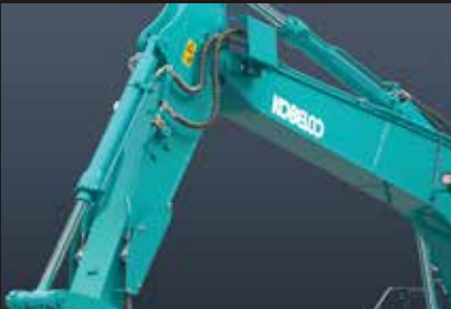
アーム配管ガード/ブーム配管ガード（オプション） 立木や伐採材にアームやブームが接触することによる配管損傷を防ぎます。 ※写真はSK135SR-7Fです。
