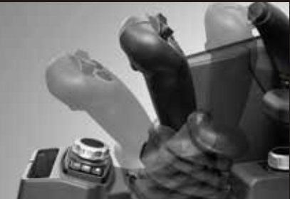
HCPレバー（オプション） スライドスイッチの操作量に対して、グラブルの旋回速度や開閉速度が変化し、手元でなめらかに操作が可能です。 ※写真はSK135SR-7Fです。
