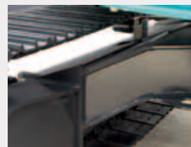
泥を落としやすい片流れクローラ フレーム
