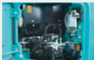
右後方ガード：油圧ポンプ/エンジン オイルフィルタ/ウォーターセパレータ ー体燃料プレフィルタ/他
