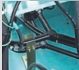
圧力損失を抑えるY字形の継手
