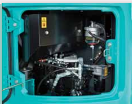
右後方ガード: 油圧ポンプ/エンジンオイルフィルタ/燃料プレフィルタ/他
