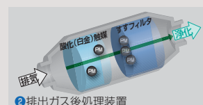
② 排出ガス後処理装置
