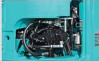
右サイド：油圧ポンプ/燃料フィルタ/ ウォーターセパレータ
