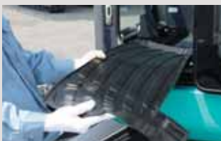
取り外しやすい耳付2分割フロアマット 下にはフロア排水口を設置
