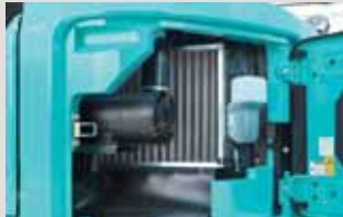
左サイド：ラジエータリザーバタンク/ エアクリーナ
