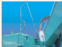
マシン上部に乗り降りしやすいハンドレール(欧州規格適合)。
