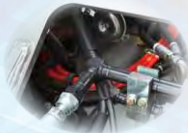
油圧損失を抑えるY字配管
