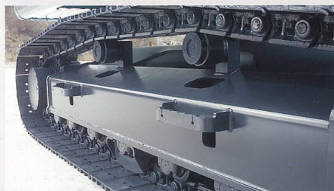
●泥落ちしやすい片流れ構造のクロウラフレーム。
