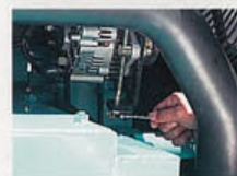
●ネジ式で微調整ができる ファンベルト
