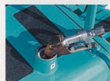
●自動給油にも対応できる よう燃料給油口を大型化。
