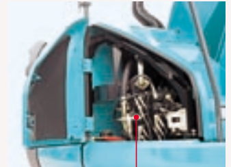
右ガード コントロールバルブ
