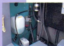
●冷却水、ウォーターセパレータ、ウォッシュ液の一元点検
