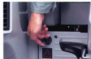
●強制的にエンジンを止めるエマージェンシーエンジンストップ
