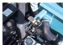
●微調整が楽な ファンベルト張り調整
